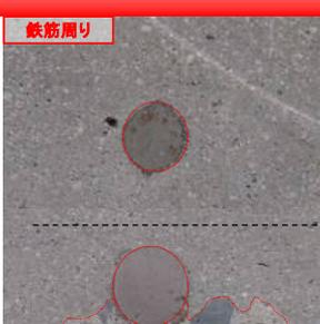
局所的な母材コンクリートの窪みや、鉄筋背面への充填も良好であった。
